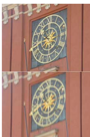
u góry zdjęcie wykonane ze stabilizacją, na dole bez, w obu wypadkach czas naświetlania wynosił 1/50 s, a ogniskowa w przeliczeniu na mały obrazek 432 mm - to na tyle długo, że bez stabilizacji lub statywu wykonanie nieporuszonego zdjęcia byłoby trudne
