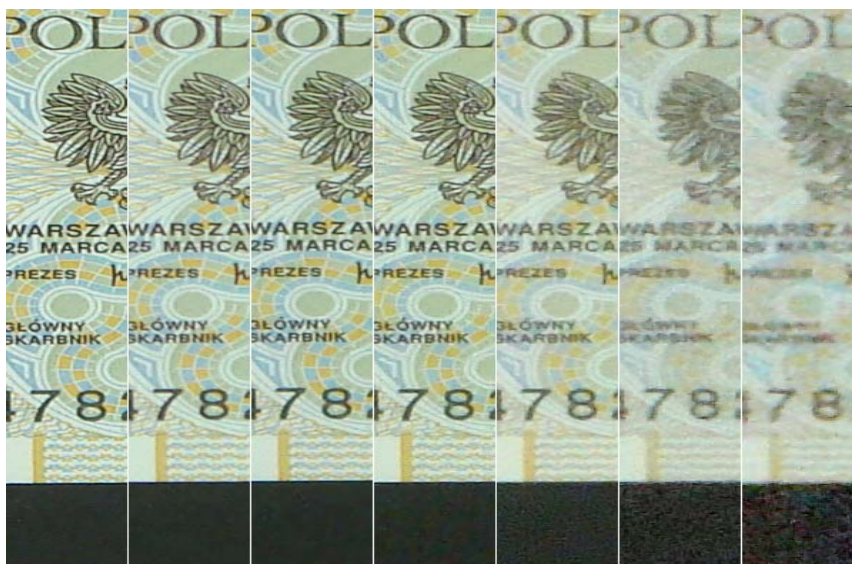
przykładowe zestawienie tego samego fragmentu banknotu sfotografowanego z wykorzystaniem różnych czułości, od lewej ISO 80, ISO 100, ISO 200, ISO 400, ISO 800, ISO 1600, ISO 3200 - widać wyraźny spadek jakości obrazu wraz ze wzrostem czułości
